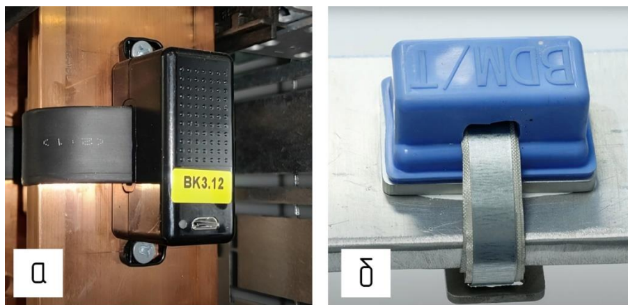
Рисунок 1 – Беспроводные температурные датчики: а – датчик комплекса «Мелисса»; б – датчик типа BDM/T
