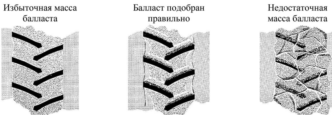
Рисунок 2 – Визуальное определение пробуксовки трактора
