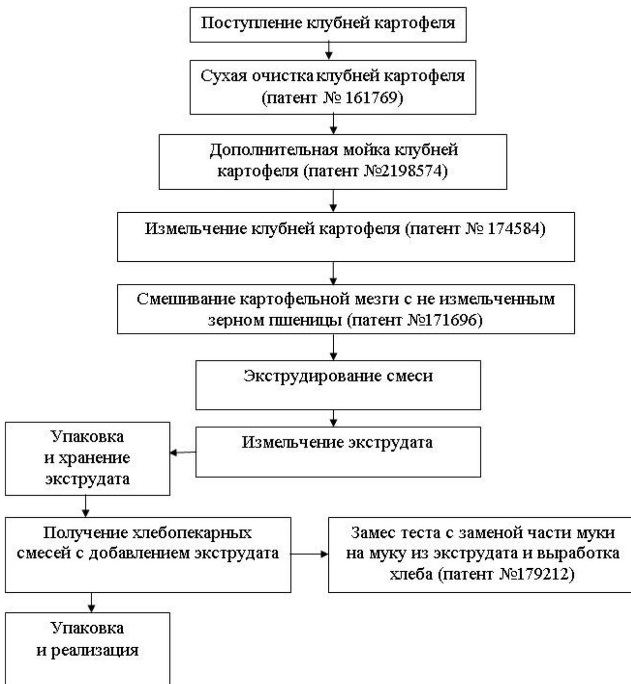
*Рисунок 1 - Технологическая схема процесса получения хлеба с использованием муки из экструдата*
