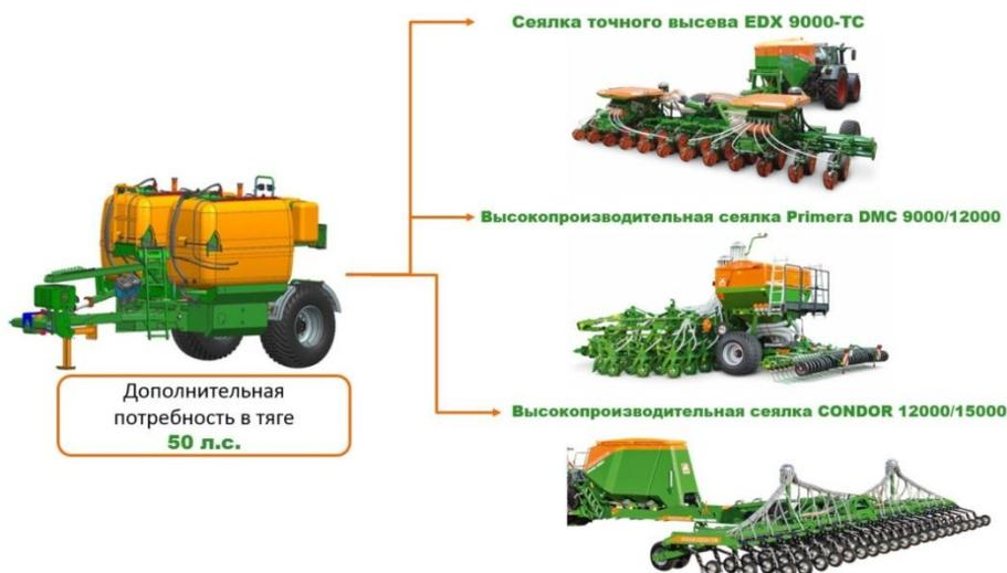
Рисунок 5 – Возможные варианты использования агрегата FDC 6000 с зерновыми и пропашными сеялками компании «AMAZONEN-Werke»: пропашная сеялка точного высева EDX 9000-TC, зерновые сеялки для классических технологий и No-Till, Mini-Till: DMC 9000; DMC 12000; Condor 12000; 15000
