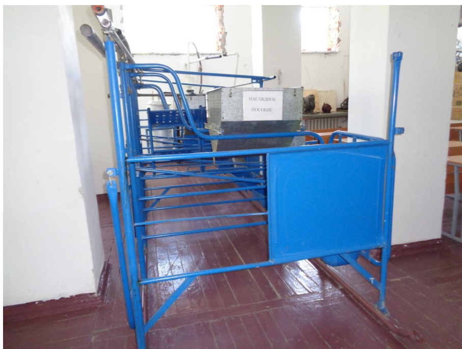
Установка доильная стационарная – 3-Б (вид у входа)
