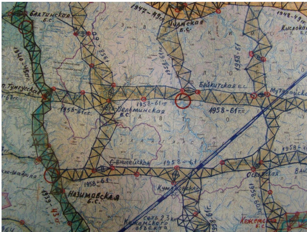
Рисунок 1 – Фрагмент Астрономо-геодезической сети 1 класса на территорию Красноярского края
