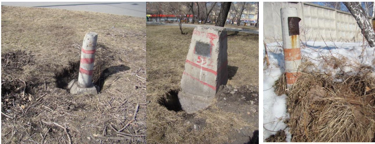
Рисунок 4 – Оповзак пункта спутника (а) и пилон пункта 1 класса высотной сети (б), оповзак пункта сети сгущения в мкр. Ветлужанка уже без центра (в)
