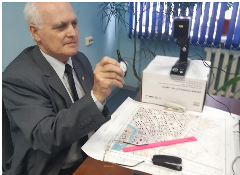
Рисунок 1 – Использование простейшего прибора для определения размеров по карте механическим способом
