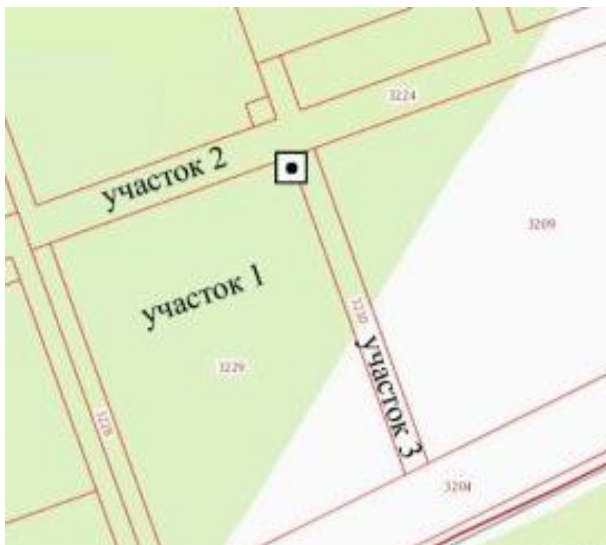
Рисунок 1 - Пункт ОМС на пересечении трех земельных участков (изображение взято из открытых источников Яндекс-картинки)
