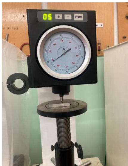
Рисунок 2 – Общий вид универсального твердомера HBRV-187,5
