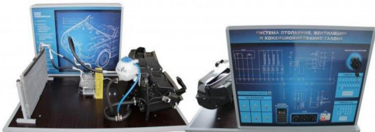
Рисунок 3 – Учебно-лабораторный стенд автомобильной климатической установки
