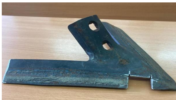
Рисунок 2 – Места вырезания фрагментов лапы культиватора
