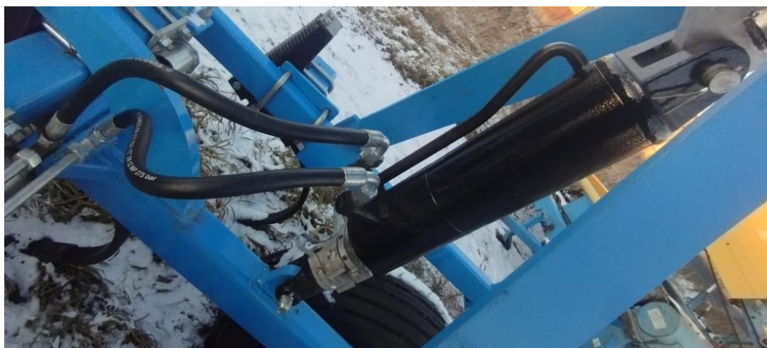
Рисунок 3 – Расположение ограничителей глубины на штоке
