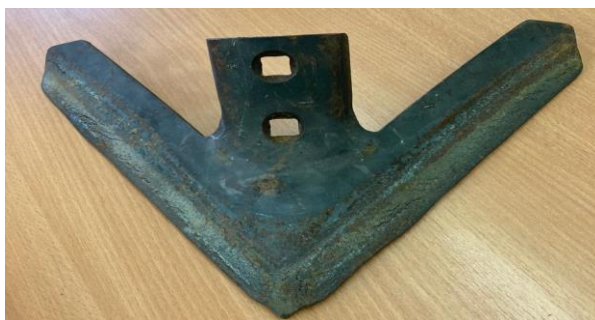
Рисунок 1 – Лапа культиватора производства компании John Deere
