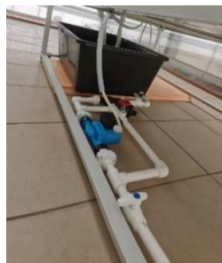
Рисунок 5 – Система циркуляции питательного раствора
