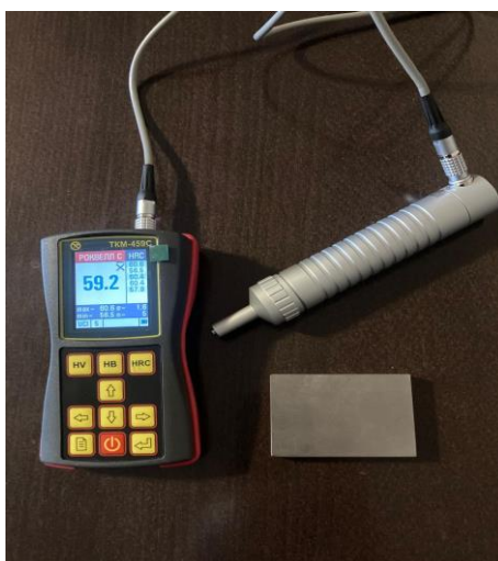
Рисунок 3 – Измерение твердости образца стали по шкале Роквелла на приборе ТКМ-459
