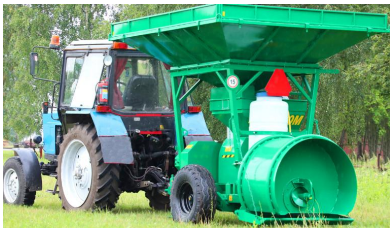
Рисунок 1 – Измельчитель-упаковщик влажного зерна ИУВ3-20М
