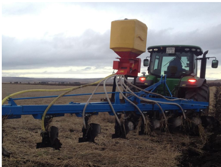
Рисунок 3 – МТА Jhon Deere 8310R + ПЛН-8-35 + Turbo-Jet Super 8
