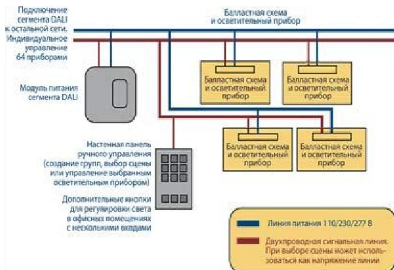
Рисунок - 1 Управление освещением по протоколу DALI
