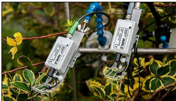
Рисунок 3 – MICRO-PAM многоканальная система мониторинга флуоресценции хлорофилла
