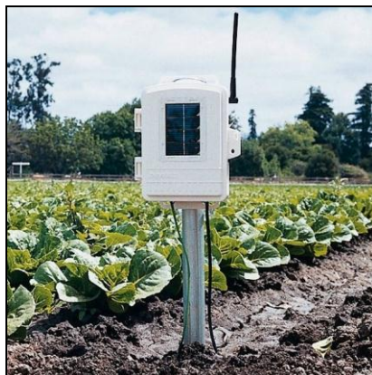
Рисунок 2 – 6345OV Беспроводная станция измерения температуры и влажности почвы
