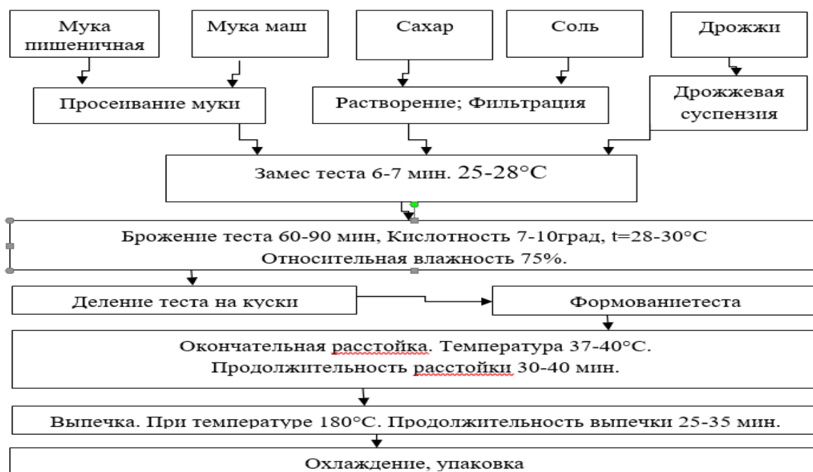
Рисунок 2. - Технологическая схема производства хлеба с добавлением муки маш
