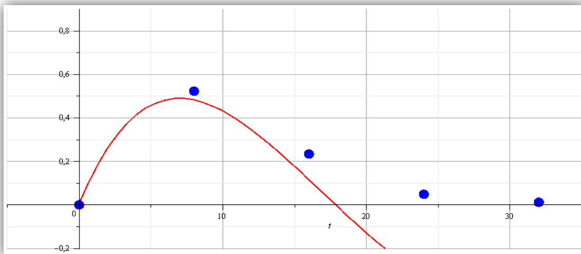
Рисунок 2 – Изменение производительности модифицированного охладителя по продолжительности работы и её интерполяция при выборе формата вычислений 2 цифровых знака, т/ч
