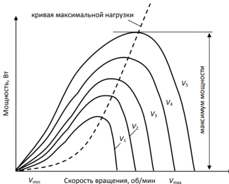
Рис. 2 – Типичные зависимости выходной мощности ВЭУ от величины нагрузки [1]
