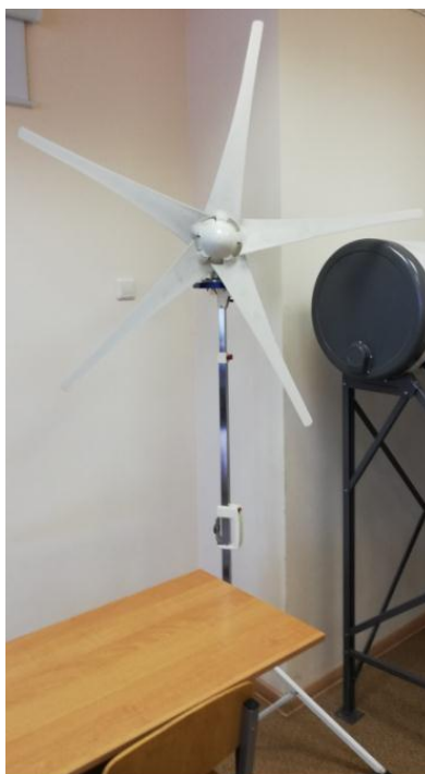
Рис. 2 – Общий вид ВЭУ Model SS – 400
