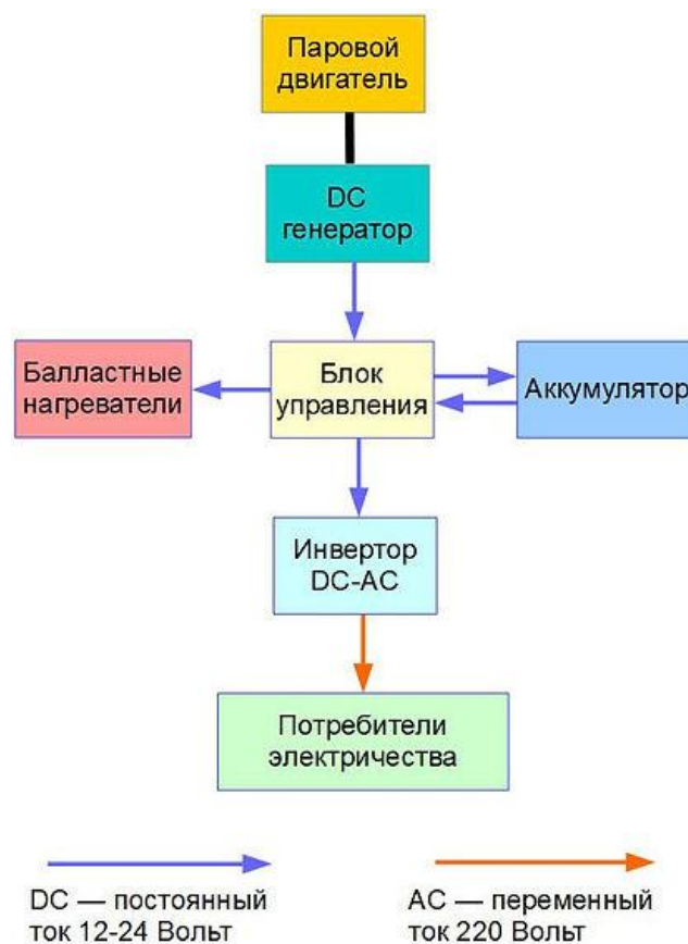
Рисунок 3 – функциональная схема генерации и преобразования электрической энергии [2]
