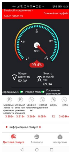
Рисунок 5 – АБ на 48В для АФЭС с 16 элементами LiFePo4 на 3,2В каждая с BMS фирмы DALY 150A, 16S BT CAN
