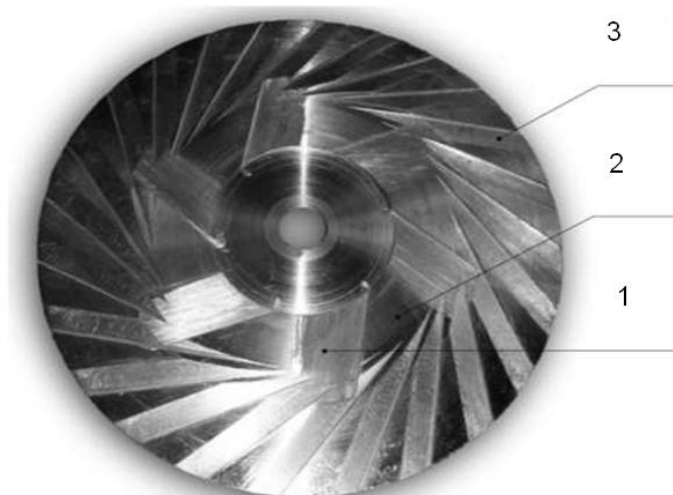
Рисунок 3 – Измельчающий диск: 1 – пояс приёма; 2 – пояс подачи; 3 – модульный пояс
