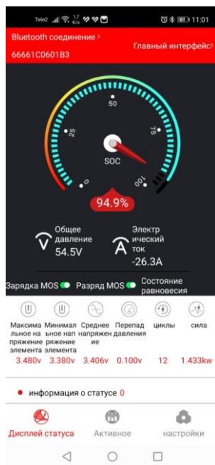
Рисунок 5 – АБ на 48В для АФЭС с 16 элементами LiFePo4 на 3,2В каждая с BMS фирмы DALY 150A, 16S BT CAN
