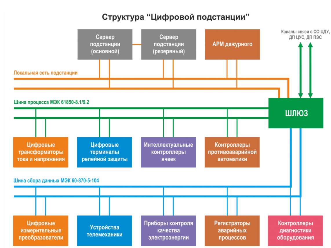
Рисунок 1 – Структура цифровой подстанции
