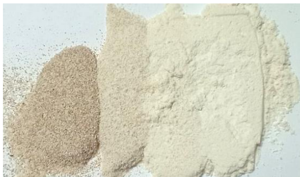
Рисунок 2 – мука производителя 3 по фракциям (слева направо сход с сит с размером ячеек 0,25 мм, 0,160 мм, 0,100 мм, 0,087 и остаток на поддоне)
