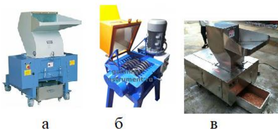
Рисунок 1 – Общий вид измельчающего оборудования а. дробилка тс-300; б. шредер Ишм-220; в. измельчитель KS- GBT-75
