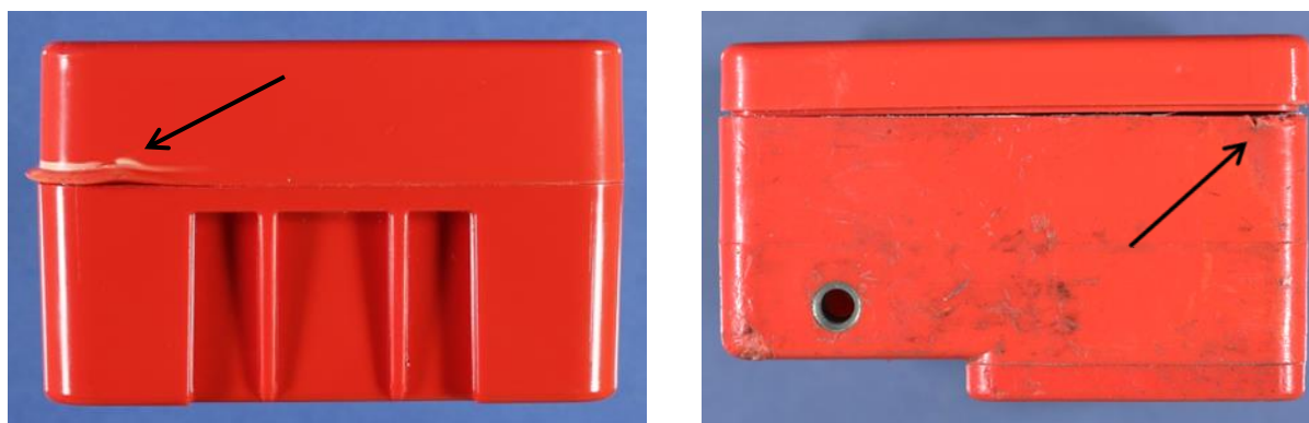
Рисунок 3. Следы деформации при попытках отделения крышки ЭК от корпуса (показаны стрелками)
