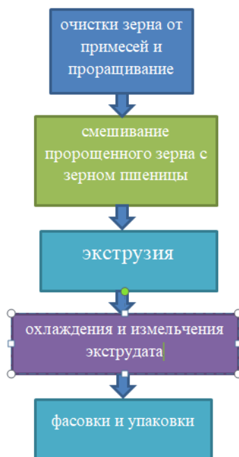
Рисунок 1 - Схема технологического процесса производства текстурированной муки из пророщенного зерна
