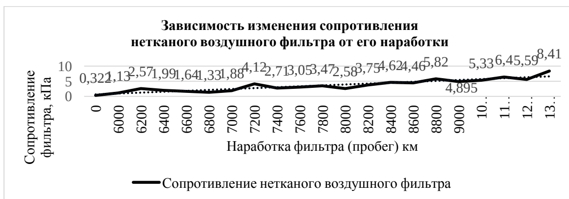
Рисунок 3 – Исследование зависимости изменения сопротивления нетканого фильтра от его наработки
