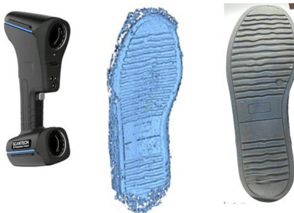
Иллюстрация №3. Изображение 3D модели следа подошвы полученной при помощи «SCANTECH AXE-B17» (разрешение 0,2 мм)
