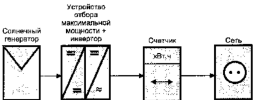
Рисунок 2 – Сетевая фотоэлектрическая станция
