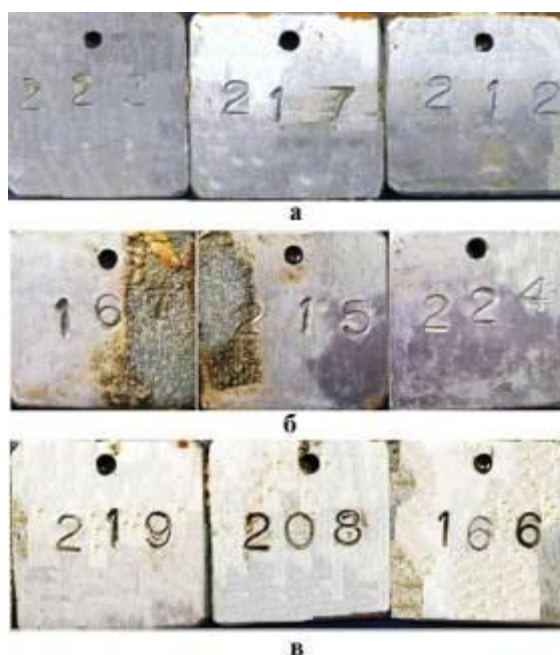
Рисунок 1 – Фотографии образцов стали, покрытых масляными композициями на основе И-20А (а), М-10Г 2 (к) (б), ММО (в) с 5 масс. % Cortec VpCI-369 после проведения испытаний в 0,5 М растворе NaCl
