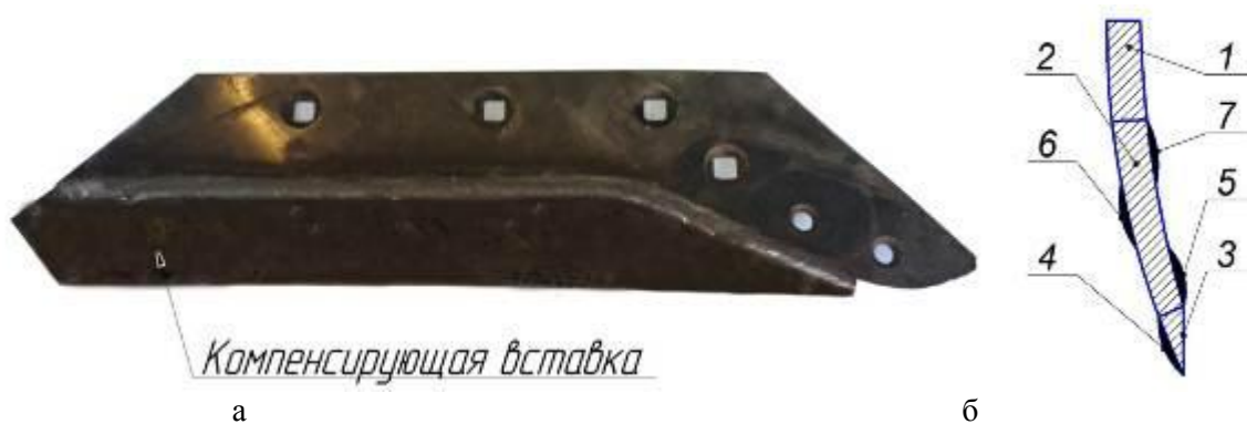
Рисунок 1 – Восстановление и упрочнение лемехов:
