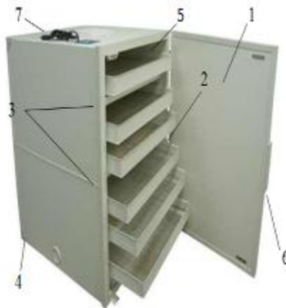
Рисунок 1 – Внешний вид сушильного кафа: 1 - дверца; 2 - сита; 3 - рейки и угольники для сит; 4 -прямоугольный наружный корпус; 5 - рабочая камера; 6 - панели управления; 7 - кабель.
