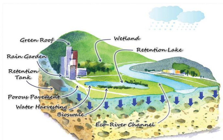
Рисунок 1 – Принцип работы города-губки
