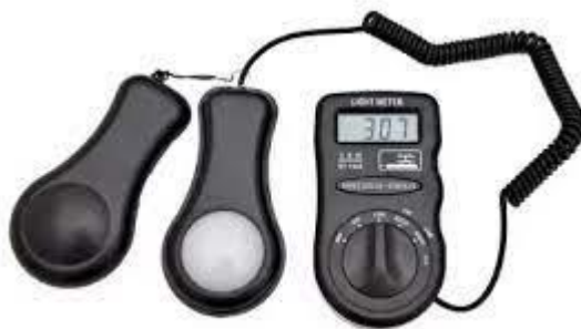
Рисунок 1 – Люксметр СЕМ DT-1300.
