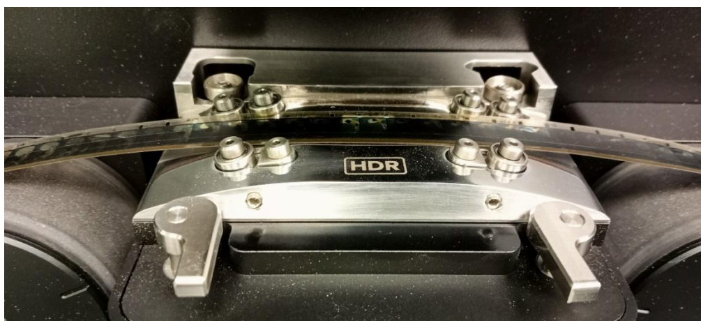
Рисунок 2 – Процесс сканирования 16 мм киноплёнки
