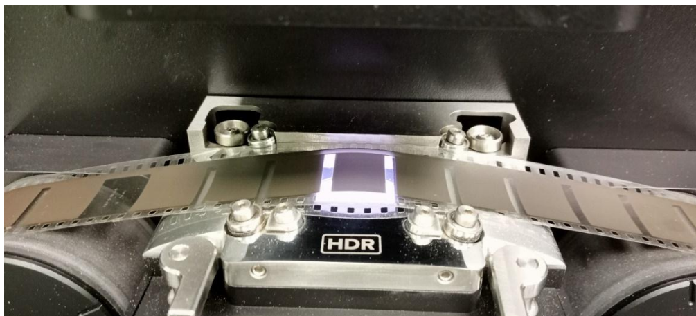
Рисунок 1 – Процесс сканирования 35 мм киноплёнки
