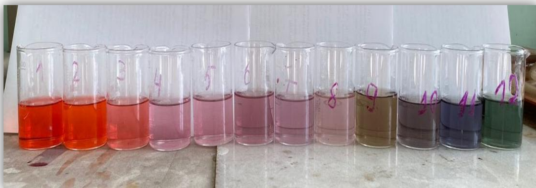
Рисунок 1 – Оттенки водных растворов сока аронии (гидромодуль 1:5) при изменении значений pH от 1 до 12.
