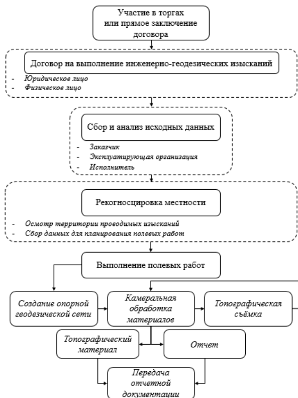
Рисунок 1 – Технологическая схема проведения инженерно-геодезических изысканий в отношении сооружения
