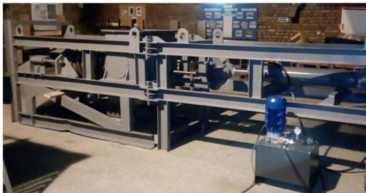
**Рисунок 5 – Общий вид гидравлического пресса для влажного фракционирования зеленых растений**
