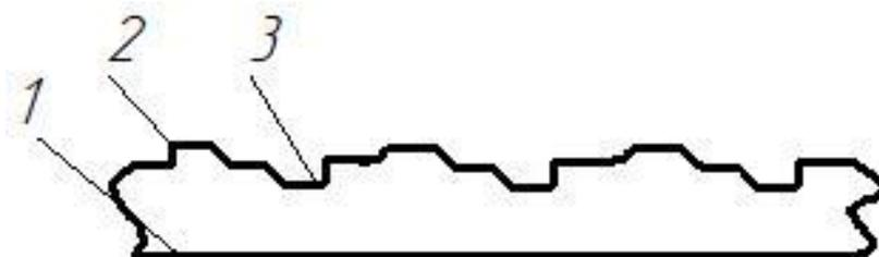
**Рисунок 8 – Вид стенки на участке расширения (В): 1 – боковая стенка; 2 – выступы; 3 – углубления**
