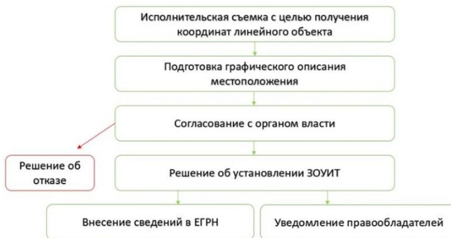
**Рисунок 1 – Порядок установления охранных зон**
