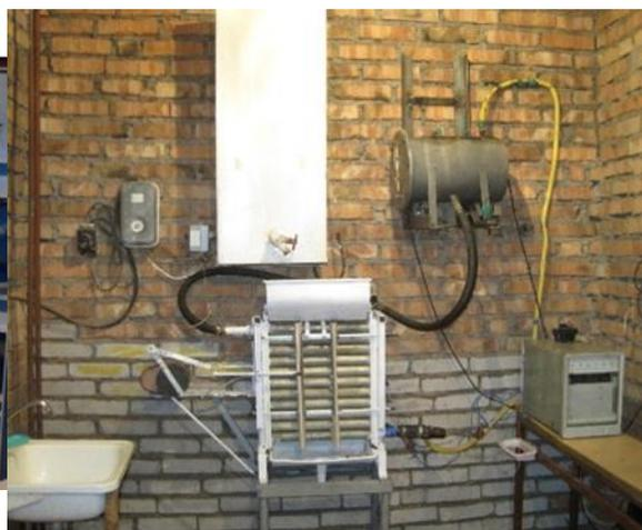
**Рисунок 6 – Общий вид экспериментальной установки для получения белково-витаминного коагулята**
