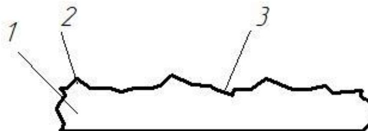
**Рисунок 7 – Вид стенки на центральном участке (Б): 1 – боковая стенка; 2 – рифли треугольной формы, 3 – углубление**
