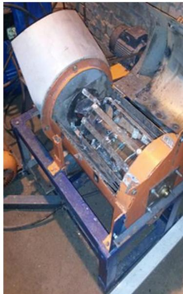
**Рисунок 3 - Общий вид экспериментальной установки для сухой очистки картофеля**
