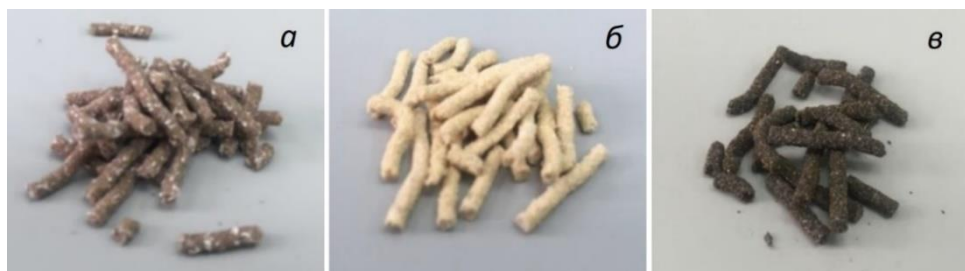
Рисунок 2.2 – Фото гранул фунгицида тебуконазола, депонированного в основу с различными наполнителями: а – П(ЗГБ)/глина, б – П(ЗГБ)/опилки, в – П(ЗГБ)/торф
