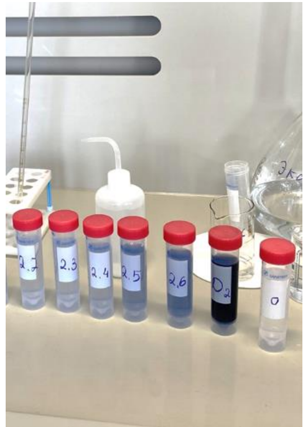
Рисунок А.11 – Построение градуировочного графика и определение массовой концентрации подвижного фосфора в пахотном слое почвы экспериментального участка по методике ГОСТ Р 54650-2011
