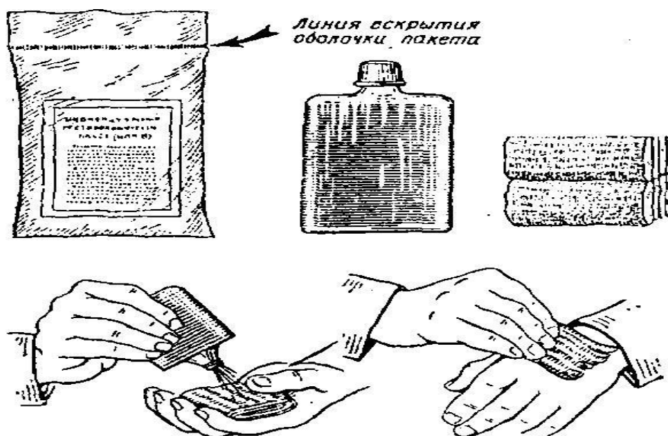
Рис.3. Индивидуальный противохимический пакет ИПП-8 и пример пользования им.
