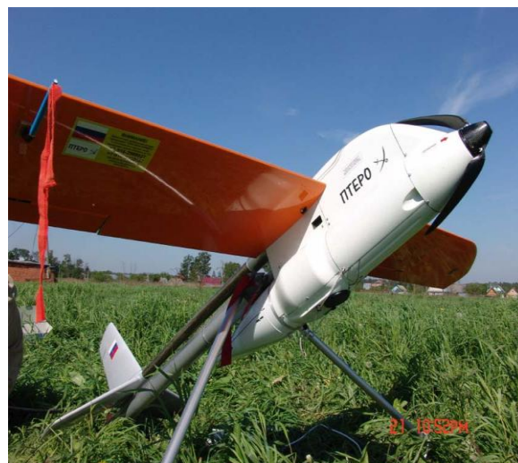
Рисунок 19 – Беспилотный летательный аппарат комплекса «Птеро»
