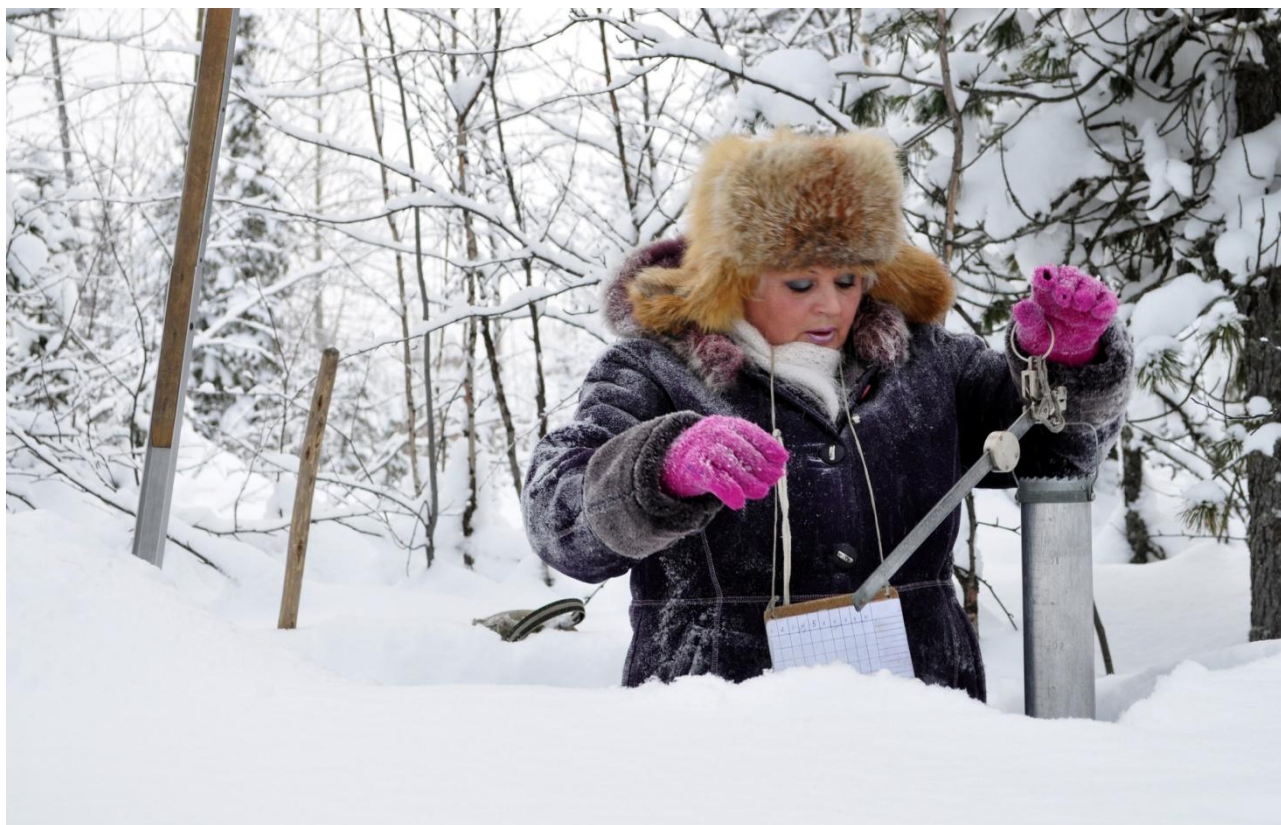
Снегосъёмка. Определение влагозапаса в Туруханске
