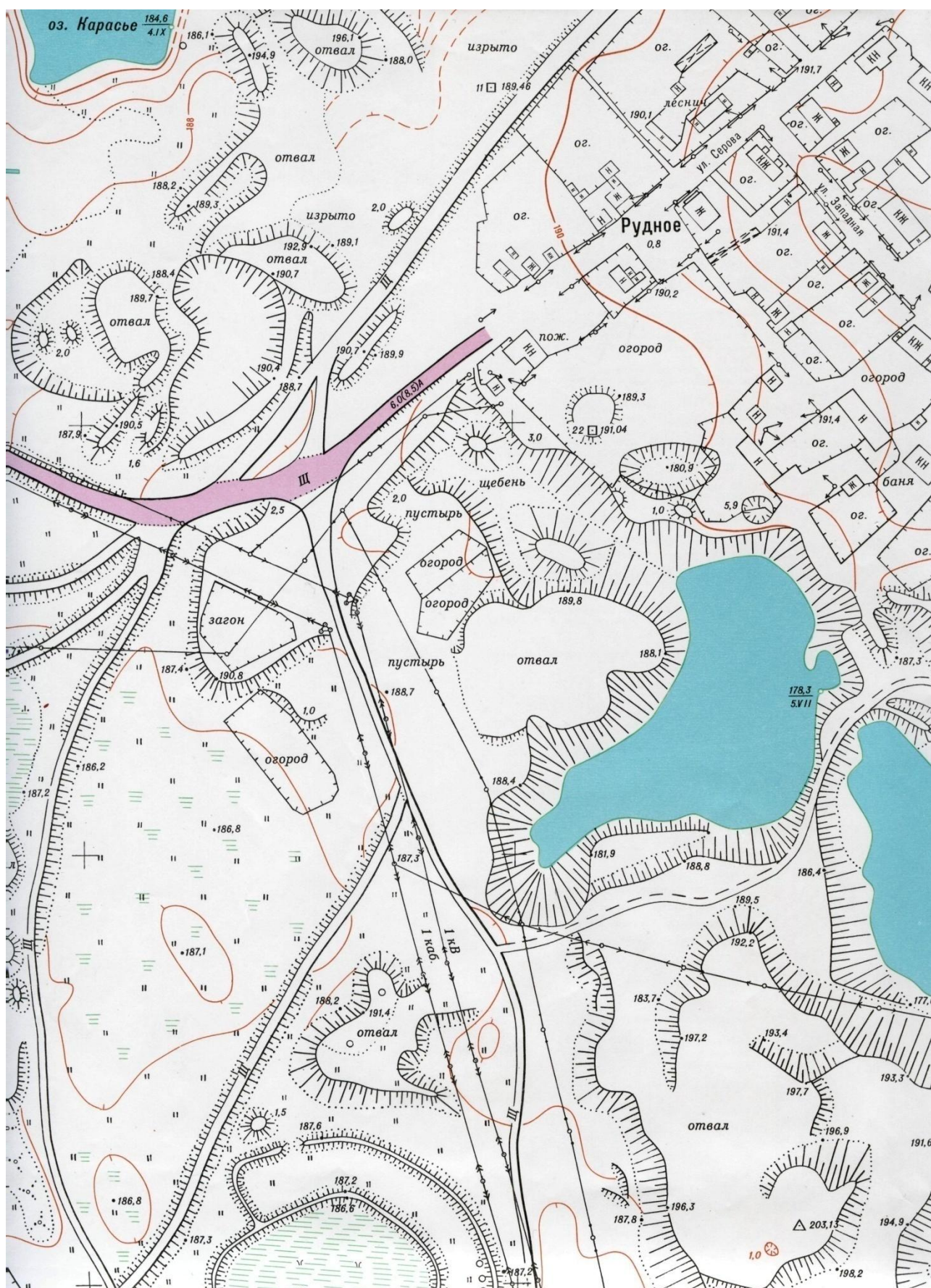
Рисунок 14 – Фрагмент топографического плана на сельский населенный пункт Рудное в масштабе 1:2 000 (с тремя пунктами геодезических сетей)
