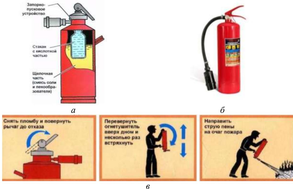
Рис. 3.8. Огнетушители ОХП: а – устройство; б – внешний вид; в – порядок работы
