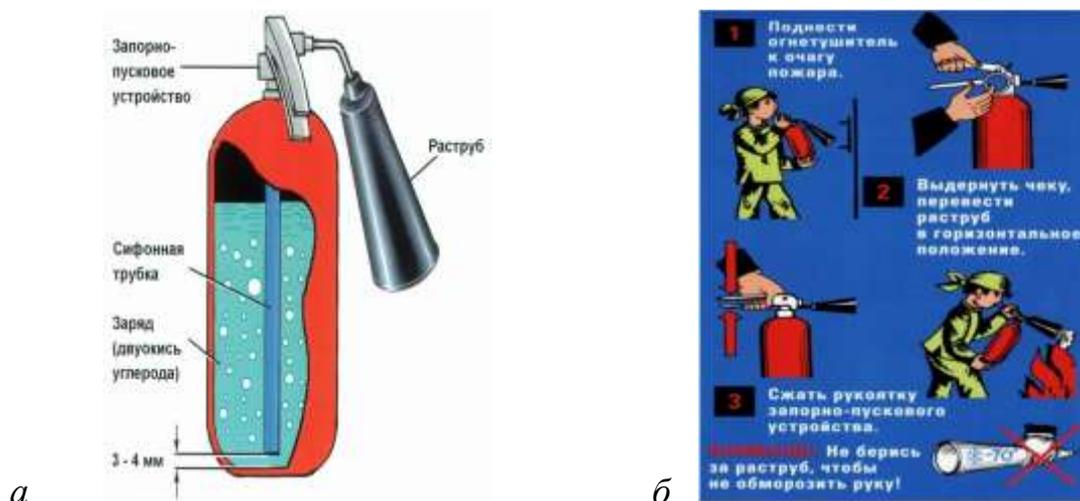
Рис. 3.10. Огнетушители ОУ: а – устройство; б – порядок работы
