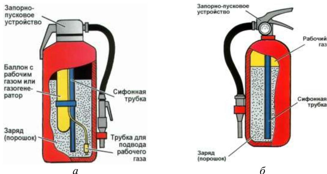
Рис. 3.11. Огнетушители ОП: а – со встроенным баллоном; б – закачной
