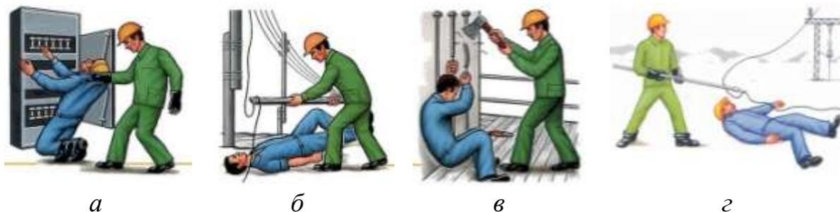
*Рис. 3.43. Способы освобождения от действия электрического тока: а – оттаскивание за одежду; б – снятие провода с тела; в – перерубание проводов; г – изолирующей штангой (в установках выше 1000 В)*
