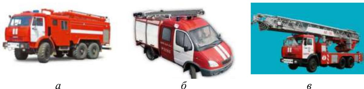
Рис. 3.3. Пожарные автомобили: а – автоцистерна пожарная АЦ-5,0-40 (КамАЗ); б – автомобиль первой помощи АПП-0,5-2,0 (ГАЗ); в – пожарная автолестница
