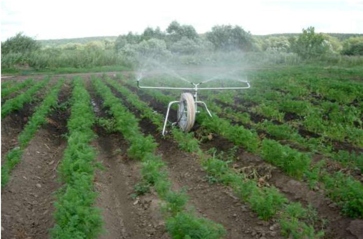
*Рисунок 7 – Дождевальная шланговая установка ДШ-1*
