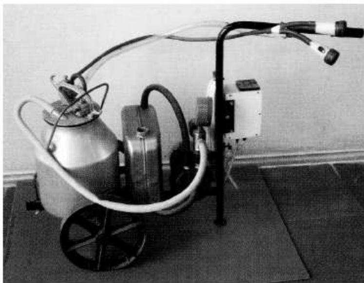
Рисунок 19.1 – Доильная установка ДДУ-2М
