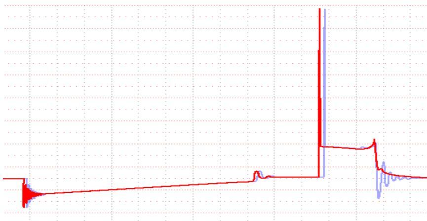
*Рисунок 13 – Неисправность катушки зажигания*
