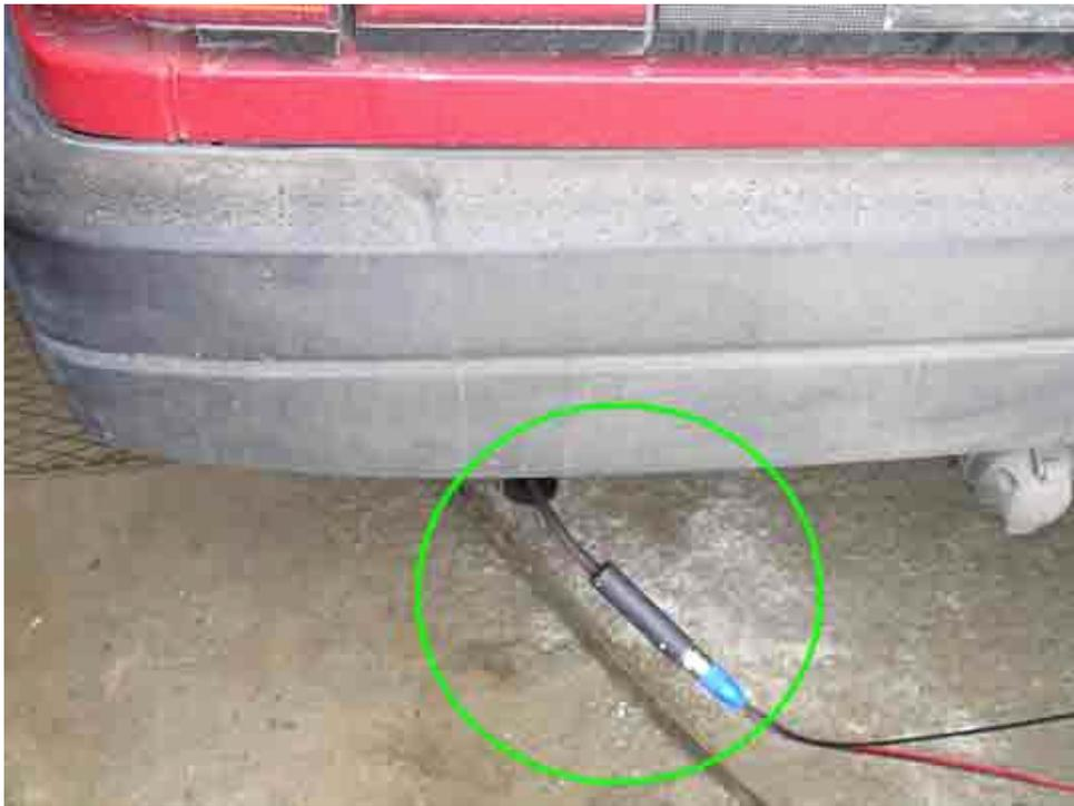
*Рисунок 59 – Подключение датчика разрежения к выхлопной трубе*
