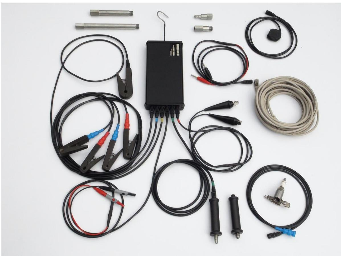
*Рисунок 16 – Комплект диагностического оборудования MotoDoc III*
