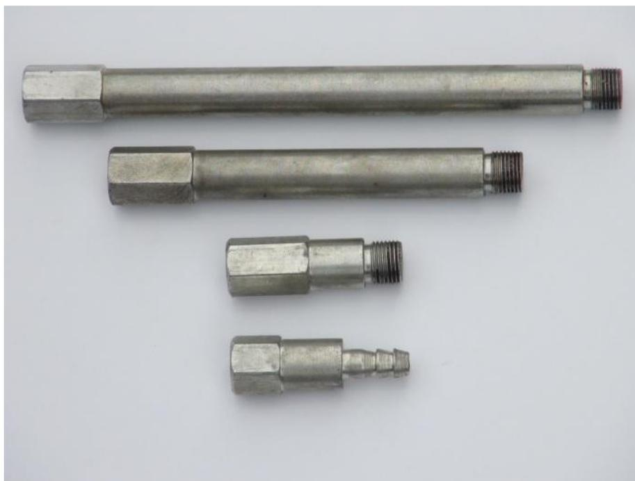
*Рисунок 24 – Комплект переходников для датчика давления  $\pm 16$  Атм*
