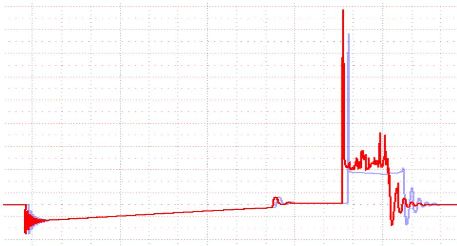
*Рисунок 10 – Загрязнение свечных электродов. Неисправность (осциллограмма красного цвета)*
