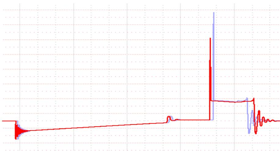
*Рисунок 7 – Заниженная компрессия или уменьшение свечного зазора. Неисправность (осциллограмма красного цвета)*
