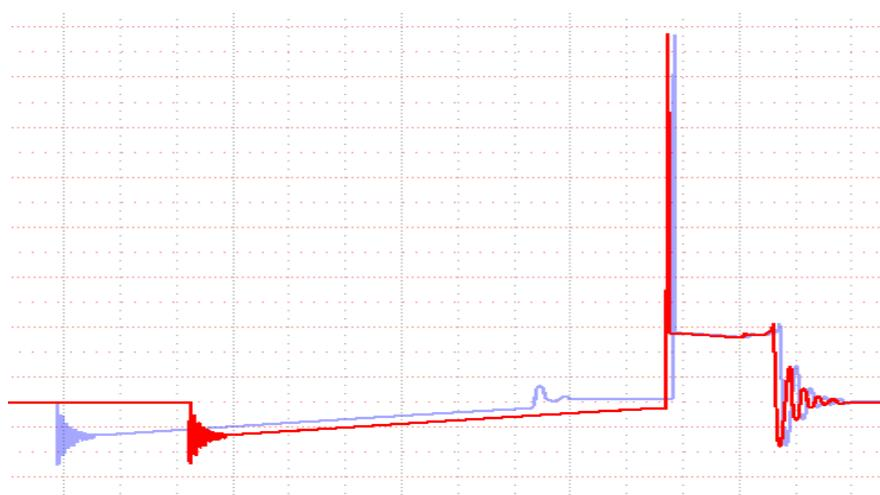
Рисунок 2 – Незначительный недозаряд катушки зажигания. Норма
