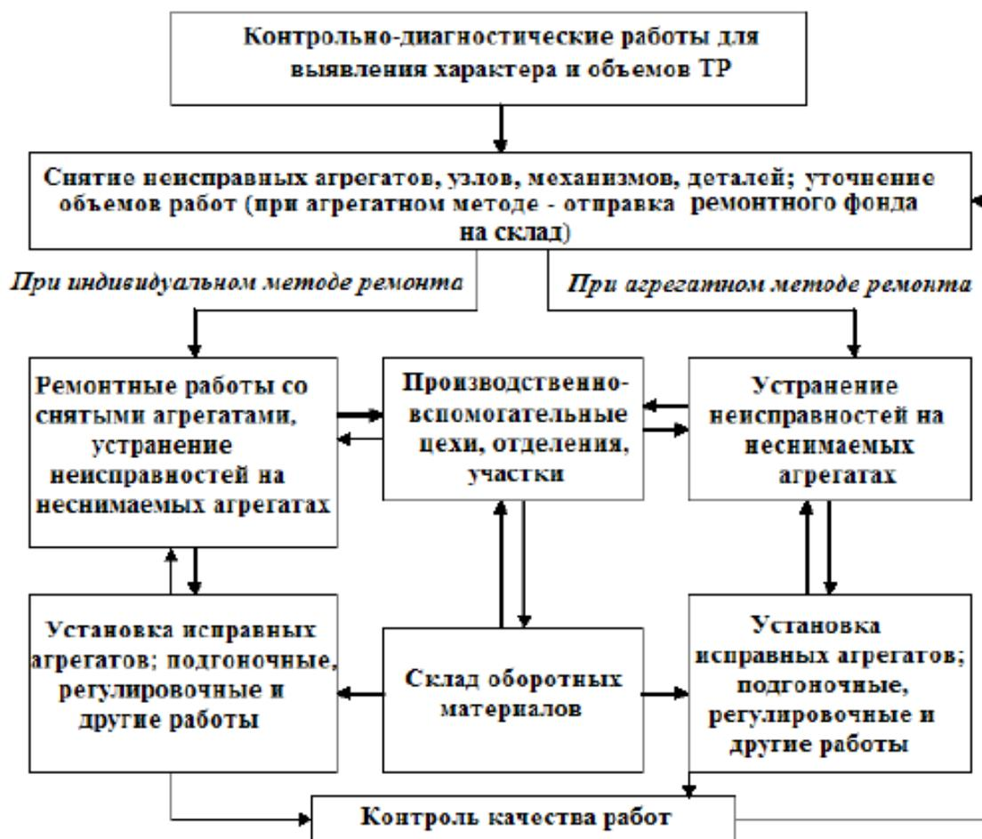
Рисунок 1 – Схема процесса текущего ремонта автомобиля
