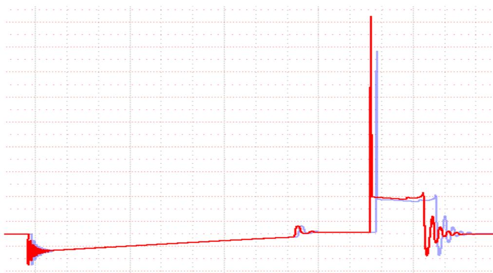
*Рисунок 6 – Режим повышенной нагрузки. Неисправность (осциллограмма красного цвета)*
