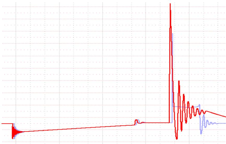
*Рисунок 12 – Обрыв ВВ провода (осциллограмма красного цвета)*
