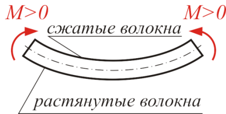
Рисунок 109 – Правило знаков для изгибающего момента
