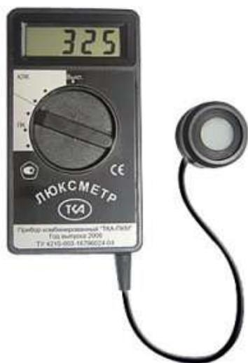
Рисунок 4 – Внешний вид люксметра
