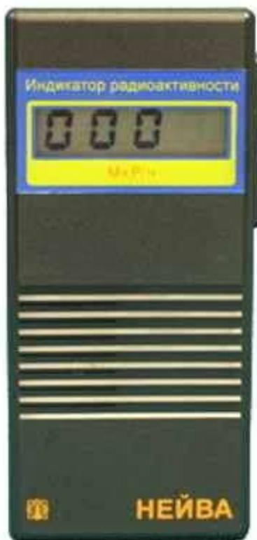
Рисунок 3 – Устройство прибора НЕЙВА ИР-002
