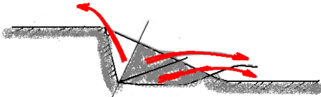
Рисунок 15.3 – Схема распределения выброшенной взрывом породы при наклонной свободной поверхности грунта
