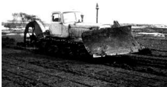
Рисунок 15.8 – Щеледренажная машина ЩДМ-1 по а.с. №№ 1301937, 1431406 и 1553623
