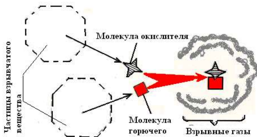
Рисунок 12.2 – Схема выделения энергии при взрыве взрывчатого вещества, представляющего собой смесь горючего и окислителя
