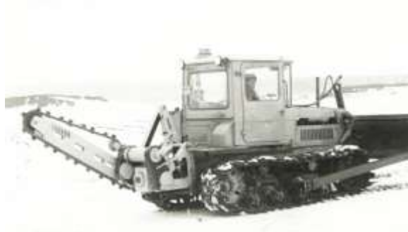
Рисунок 15.9 – Орудие дренажное навесное ОДН-1500 производства монетного РМЗ
