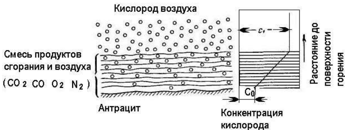
Рисунок 1.4 – Схема диффузии кислорода в зону горения твёрдого вещества (гетерогенное горение)
