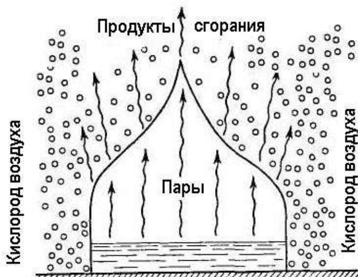
Рисунок 1.3 – Схема зоны горения паров (гомогенное горение)
