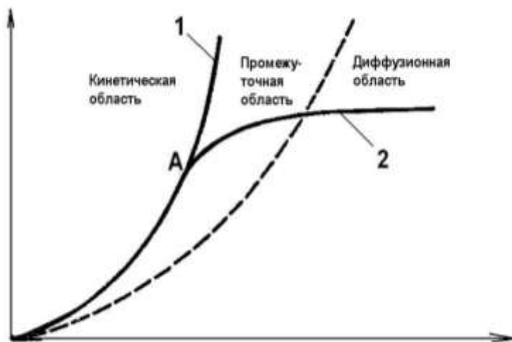
Рисунок 1.5 – Зависимость скорости кинетического (1) и диффузионного (2) горения от температуры
