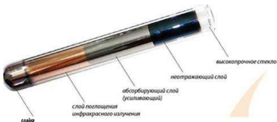
Рисунок 1.2 – Конструкция вакуумированной трубки
