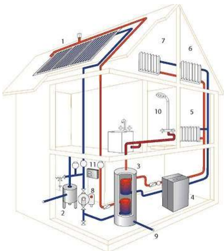
Рисунок 1.9 – Принципиальная схема ССГВ с принудительной циркуляцией теплоносителя:
