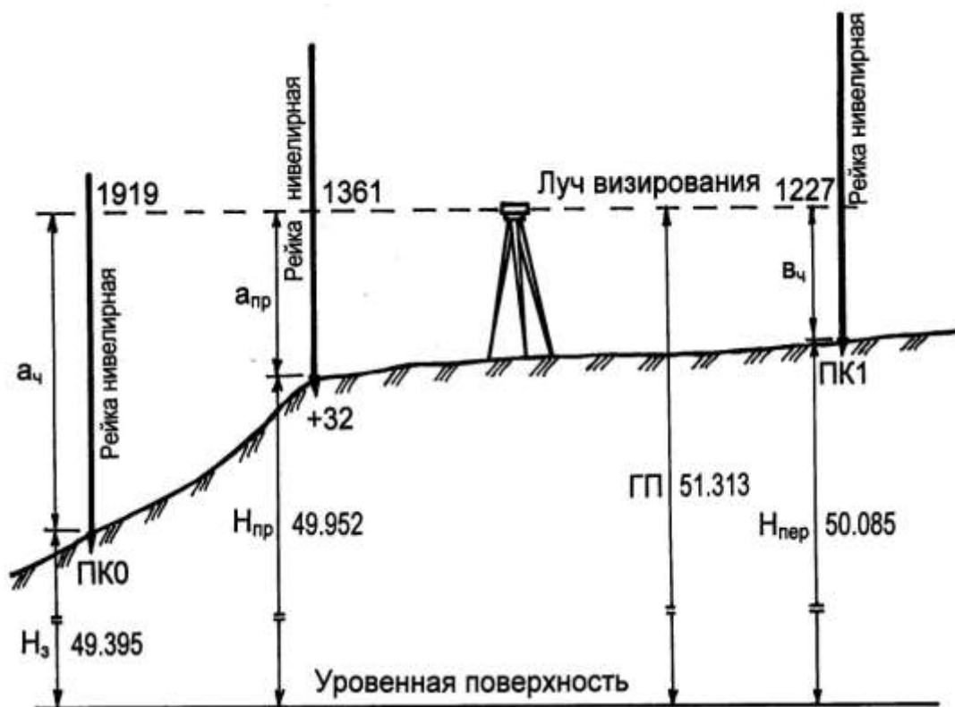
Рисунок 7.6 – Схема нивелирования на станции с промежуточной точкой
