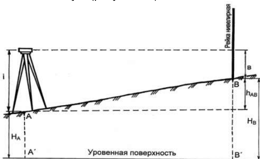
Рисунок 7.2 – Геометрическое нивелирование вперёд
