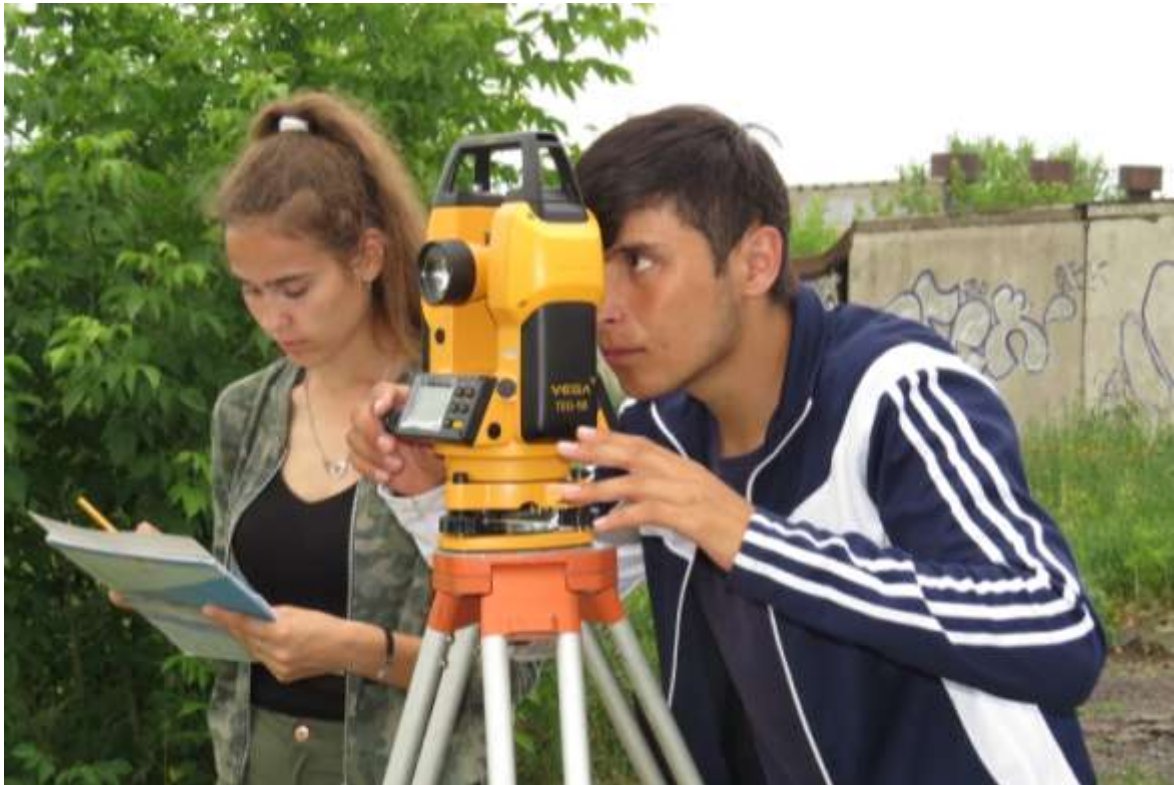
Рисунок 6.10 – Ориентирование теодолита по точке обоснования
