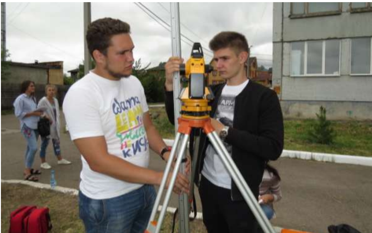
Рисунок 6.9 – Измерение высоты теодолита по метке на колонке
