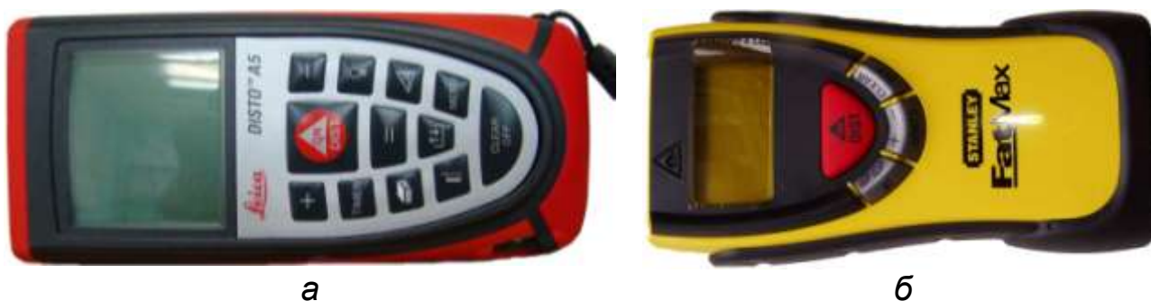
Рисунок 6.3 – Лазерный дальномер: а – Leica DISTO A5; б – STANLEY Fat Max
