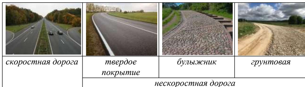
Рисунок 3 – Виды дорожного покрытия, влияющие на поверхностный сток
