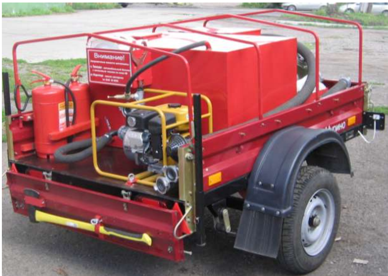
Рисунок 10.1 – Пожарно-спасательный комплекс «Огнеборец» конструкции ООО «Арника» (автор – Рогачев А.И.)
