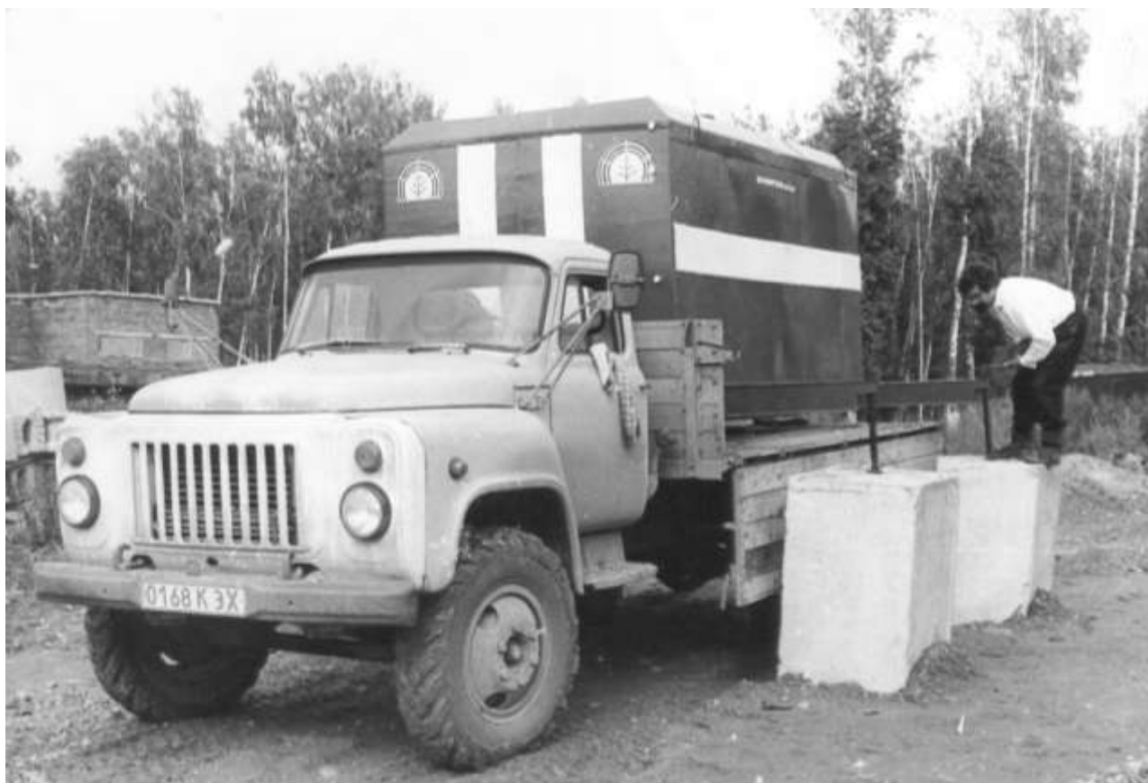
Рисунок 10.2 – Установка модуля в кузов автомобиля ГАЗ-53
