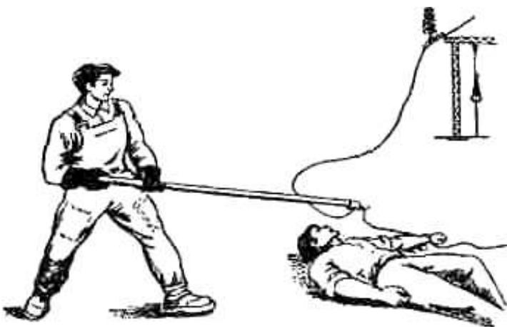
Рис. 16.4. Освобождение пострадавшего от действия тока в установках свыше 1000 В отбрасыванием провода изолирующей штангой
