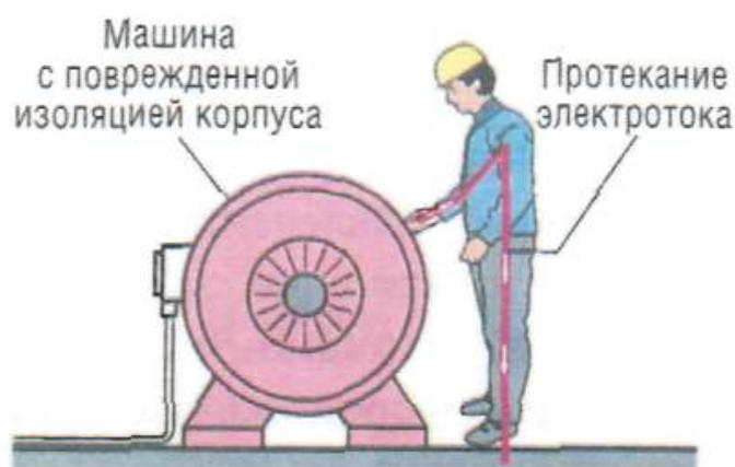
Рис. 9.1. Прикосновение человека к корпусу электрооборудования, находящегося под напряжением
