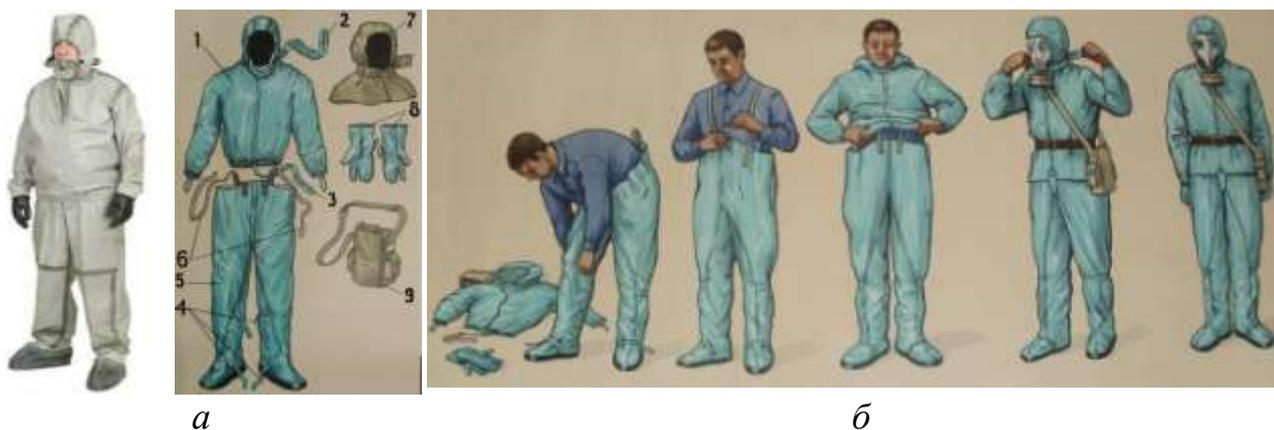
Рис. 4.15. Легкий защитный костюм Л-1 (а) и порядок надевания (б):
