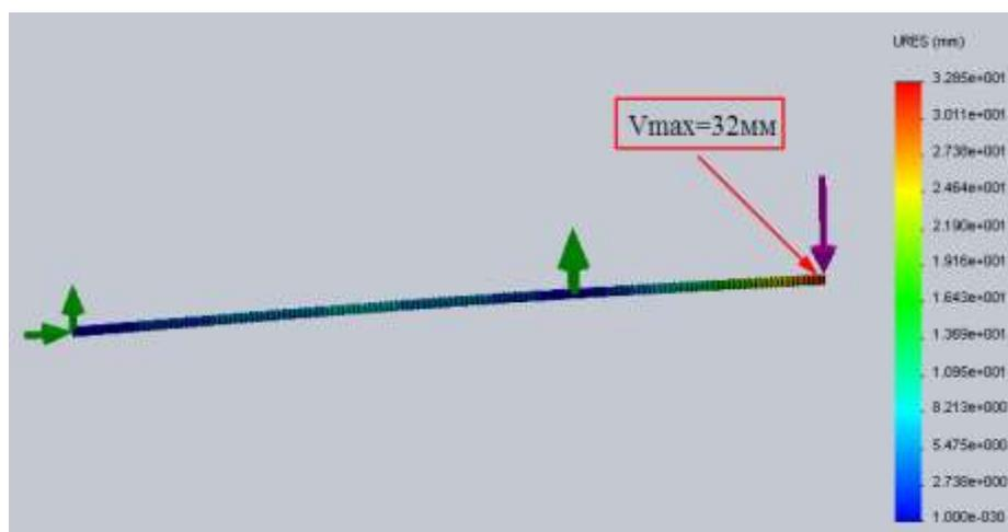
*Рисунок 4.2 – Результаты расчёта перемещений для балки прямоугольного поперечного сечения*
