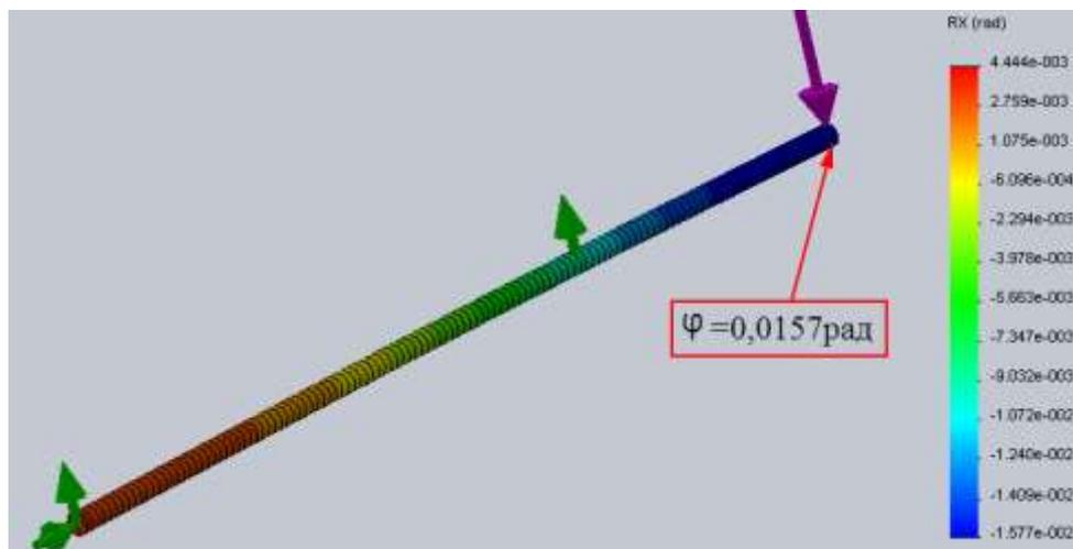
Рисунок 4.6 – Результаты расчёта угла поворота для балки двутаврового поперечного сечения
