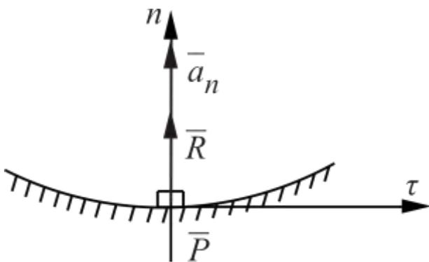
*Пример 1.* Автомобиль массы 1210 кг движется по дну оврага с постоянной по модулю скоростью  $V = 10 \text{ м/с}$ . Определить давление автомобиля на дно оврага  $R$  в нижней точке, где радиус кривизны составляет  $\rho = 50 \text{ м}$ . Силой сопротивления движению пренебречь.
