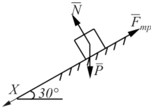
*Пример 2.* Тяжелое тело начинает движение по наклонной плоскости под действием собственного веса. Какую скорость приобретет тело через 20 с после начала движения? При решении принять угол наклона плоскости  $\alpha = 30^\circ$ , коэффициент трения  $f = 0,2$ .
