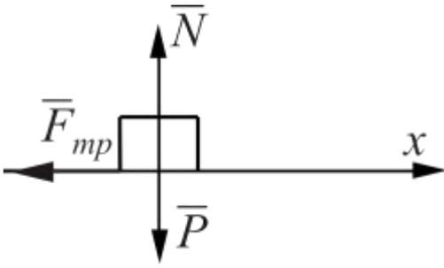
*Пример 3.* Автомобиль, двигающийся по горизонтальному прямолинейному участку пути со скоростью  $V = 20 \text{ м/с}$ , в результате экстренного торможения останавливается через  $t = 4 \text{ с}$ . Каков коэффициент трения между покрышками автомобиля и покрытием дороги?
