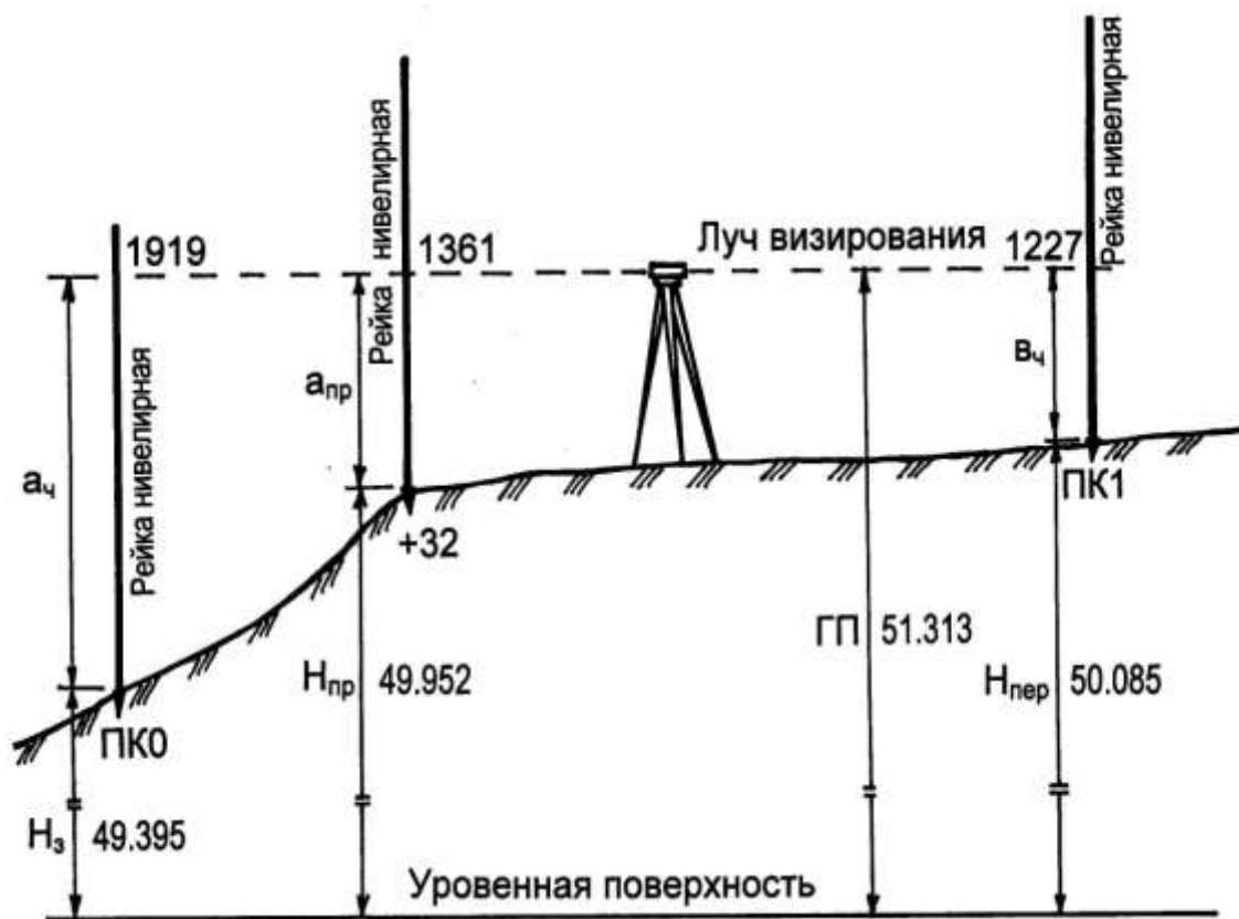
Рисунок 5 – Схема нивелирования на станции с промежуточной точкой
