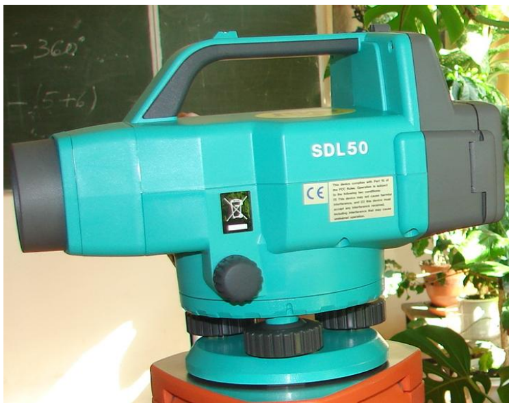
Рисунок 2 – Комплект к нивелиру SOKKIA: а – нивелир SDL 50; б – штатив T2N-L; в – рейка ND345124–103
