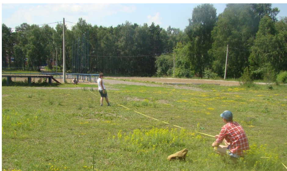
Рисунок 20 – Контрольный промер четвертой стороны и закрепление вершин квадратов по ней
