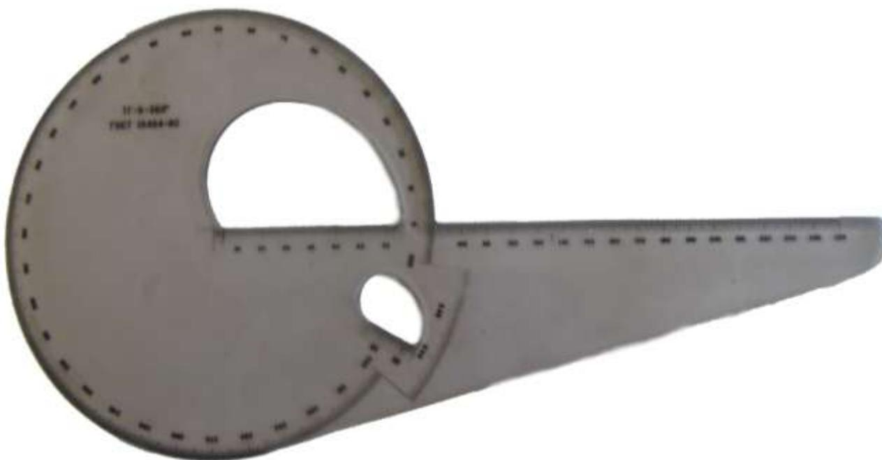
*Рисунок 15 – Тахеограф ТГ-Б-360°*
