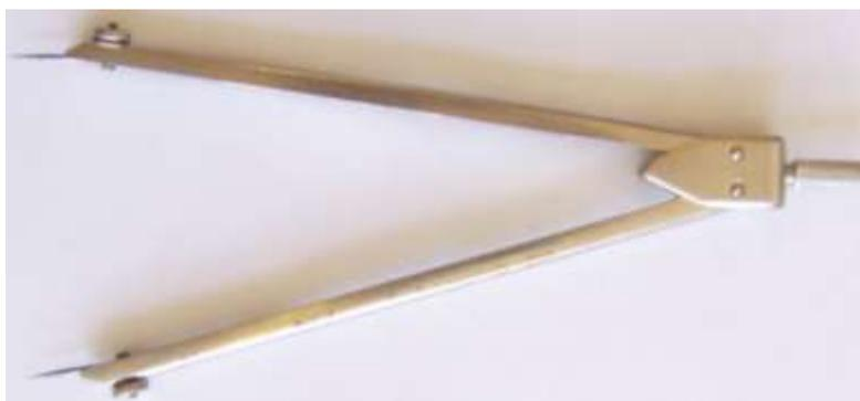
*Рисунок 11 – Циркуль-измеритель*
