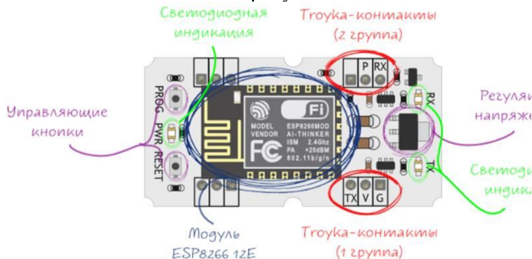
Рисунок 15. Элементы модуля ESP 12F
