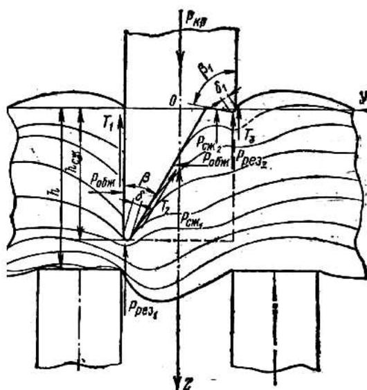
Рисунок 1 – Схема действия сил при двухопорном резании
