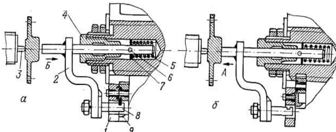
Рисунок 9 – Автомат отключения измельчителя от электросети в положениях: а – включен; б – выключен: 1, 9 – поводки; 2 – замок; 3 – кнопка путевого выключателя; 4 – штуцер; 5 – пружина; 6 – шплинт; 7 – шайба; 8 – палец
