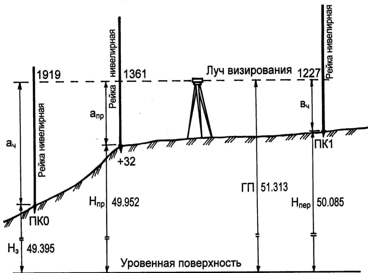
Рисунок 1 – Схема нивелирования на станции с промежуточной точкой
