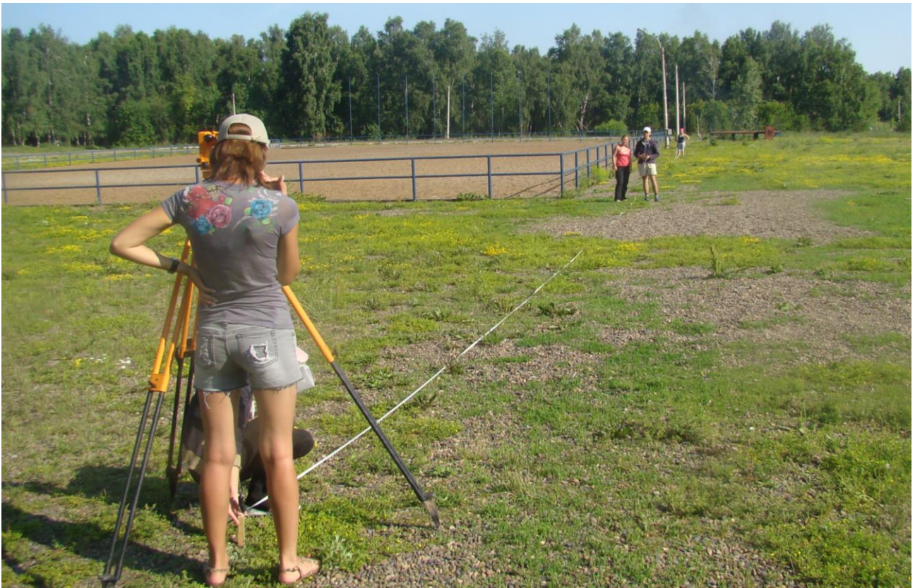
Рисунок 8.1 – Разметка базисной линии
