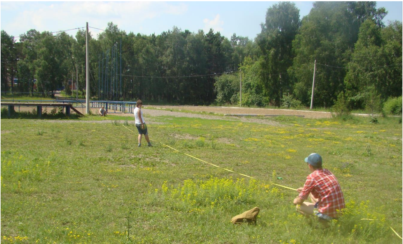
Рисунок 8.3 – Контрольный промер четвёртой стороны и закрепление вершин квадратов по ней
