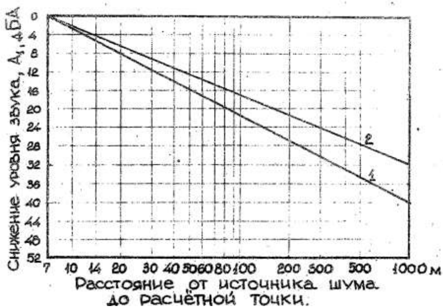
Рисунок 6 – График для определения снижения уровня звука в зависимости от расстояния между источником шума и расчетной точкой. 1 – точечные источники; 2 – линейные источники (автотранспортные потоки; железнодорожные поезда)
